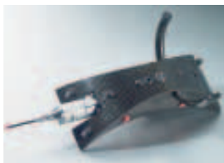
T-Probe für die Messung auch in Vertiefungen
