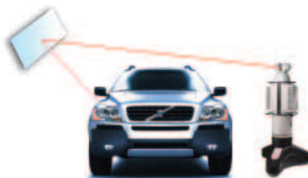
Der LR200 misst über einen Spiegel sogar Objektrückseiten.
