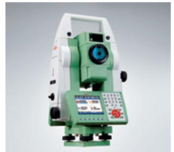
Simplemente conecte su Leica Viva TS15/TS11 a un teléfono móvil mediante una conexión inalámbrica Bluetooth™ para acceder a Internet y enviar y recibir fácilmente datos en el campo mediante Leica Exchange.
