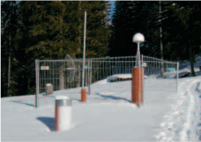
**Oben: Permanente GPS Station mit Wireless-LAN Antenne nach der Fertigstellung.**
