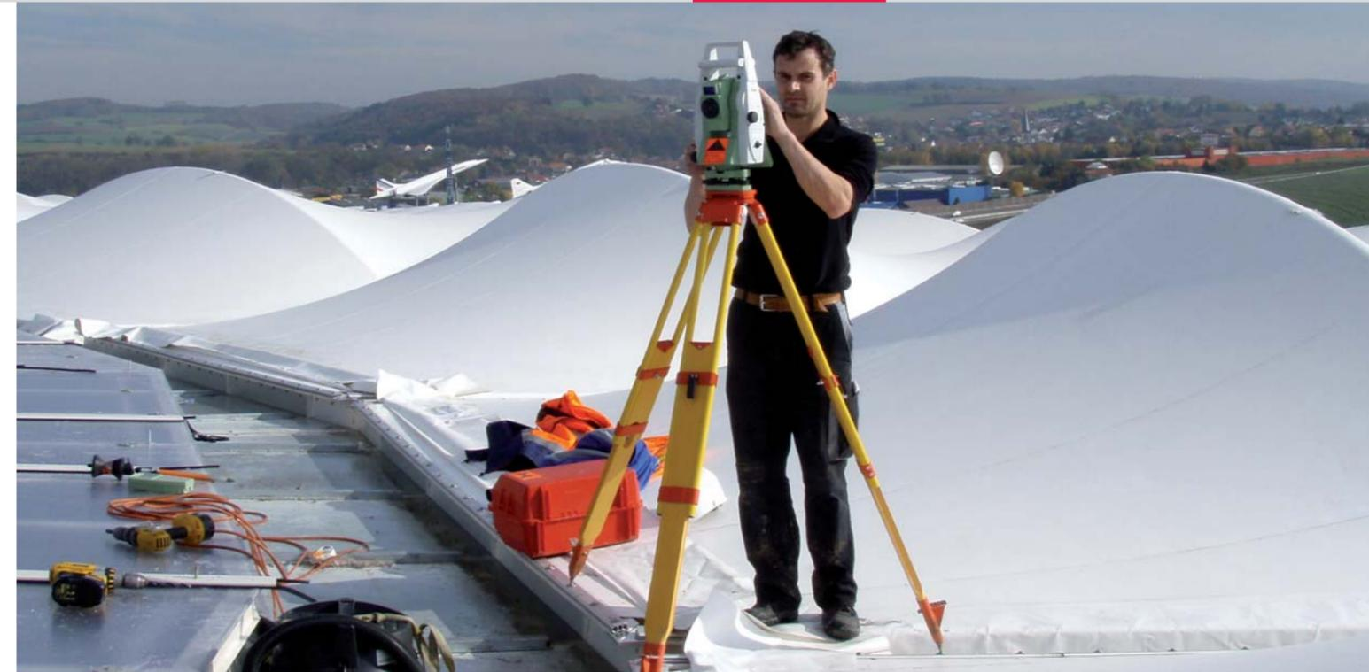
■ L'auteur, Hardy Schwalb, pendant le relevé la charpente inhabituelle avec une station Leica TPS1200.
