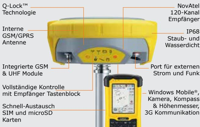
Zenith25 Empfänger sind robust genug, um Umfallen des Lotstocks und vollständiges Untertauchen in Wasser zu widerstehen. Dank zukunftssicherer Technologie die GPS, Glonass und Galileo GNSS Systeme unterstützt und kombiniert mit der unübertroffenen Q-Lock™ Technologie, die regel-mäßige, unabhängige Kontrollen durchführt ist die Zenith25 Serie für fast jede Anwendung geeignet.
