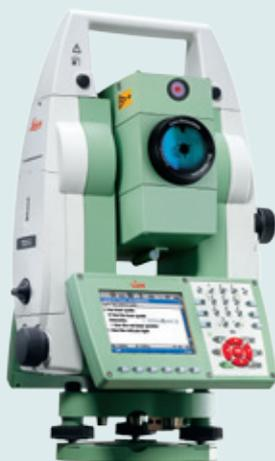
Die Leica Viva TS15 G ist eine Totalstation die speziell für den Einsatz im Tunnelbau entwickelt wurde. Mit dem kleinen roten Laserpunkt ist sie ideal für die Führung von Tunnelbohrmaschinen oder die Visualisierung von Bohrlöchern beim Sprengvortrieb.
