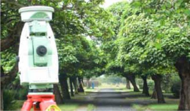
ライユーザーのアグリパワー社のレポートには、TPS1200 に GPS1200 - RTK ソリューションを統合するメリットが記載されています。これはイギリスのハリンジエイにある広大なレクリエーショングラウンドの測量事例です。通常、アグリパワー社は広域エリアの測量には GPS1200 を使います。短時間でデータ収集するために GPS を 4 輪バギーにのせて使うことが多いとのこと。今回の現場では、GPS テクノロジーとトータルステーションを組み合わせると同じ現場で使うことにより、余分な作業を省き、作業時間の短縮を図ることができました。もちろん操作は簡単で、GPS とトータルステーションの間で測定データを受け渡すことも簡単にできます。
