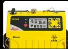
Вся информация, относящаяся к GNSS, доступна на встроенном дисплее. Для настройки приемника не требуется дополнительного контроллера или устройства.
