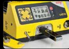
Простое обновление микропрограммного обеспечения и обмен данными с помощью модуля памяти USB.
