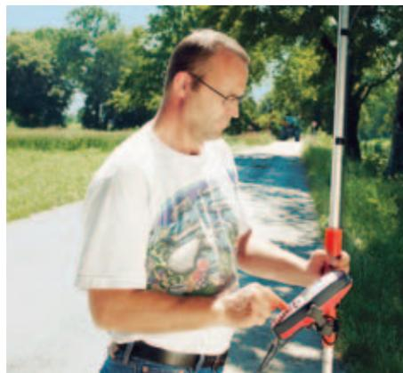
Einsatz des SR20 zur Erfassung von cm-genauen topografischen Daten im kinematischen Verfahren.
