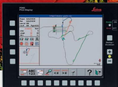
フライト時、Leica FlightPro の評価ビューを表示するパイロット・ディスプレイ Leica PD60。プロジェクトの進捗状況をグラフィック表示してオペレータをサポート。
