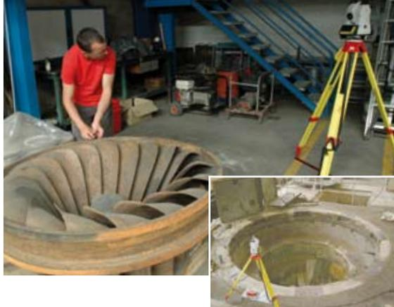
necesario fabricar una pieza nueva para una máquina antigua para la que no se dispone de planos.
