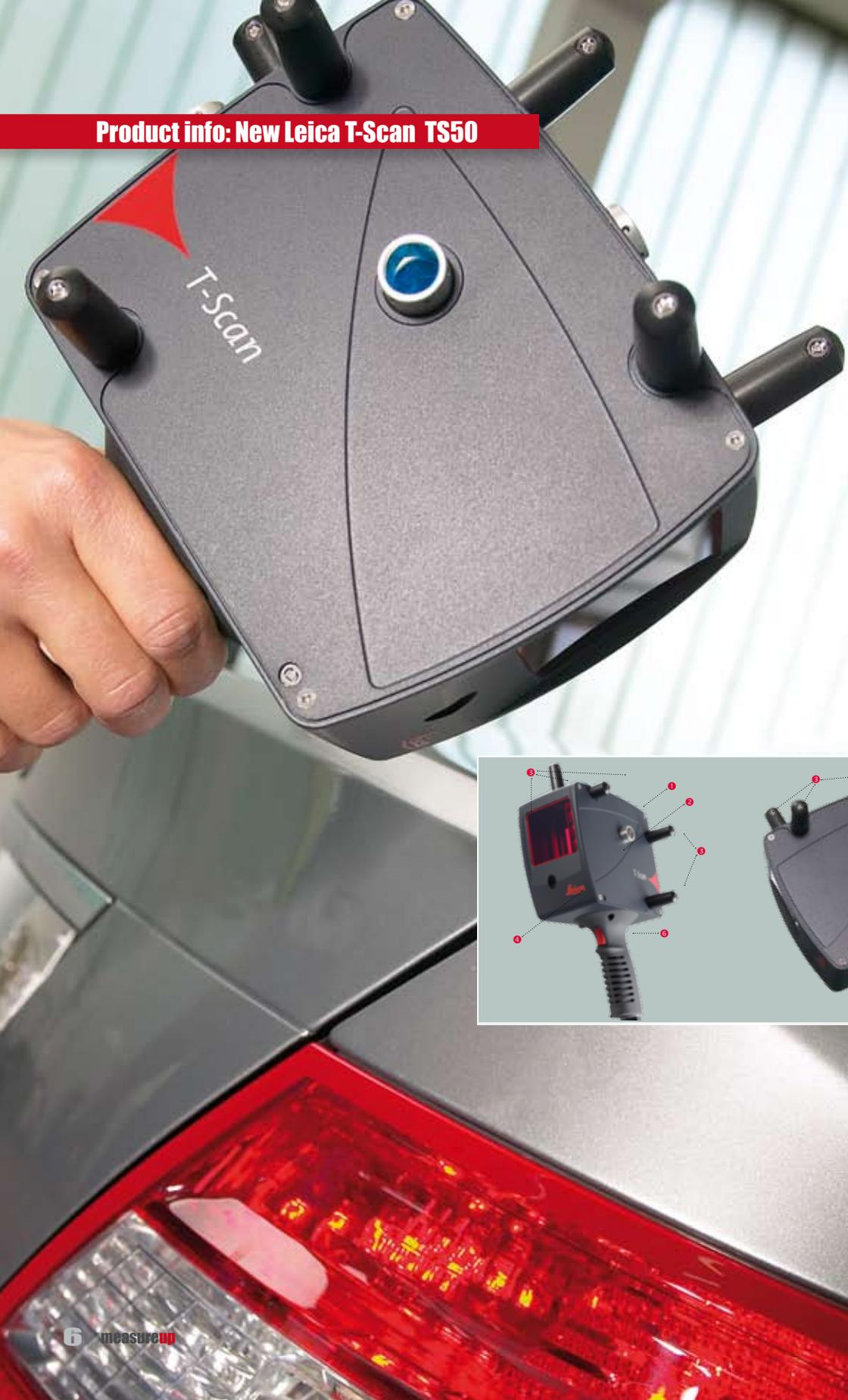
**Cuando Leica Geosystems presentó el Leica T-Scan en 2005, era el único escáner láser manual del mundo que funcionaba con un volumen de medición de hasta 30 m, prácticamente no requería preparación de la superficie y no le afectaban las condiciones de luz ambiental.**
