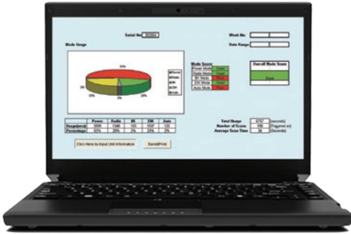
Mit der LOGiCAT Software können die auf einem Digicat 600i, 650i oder 750i der xf-Serie gespeicherten Daten hochgeladen werden. Zur Analyse der Ortungs-Verwendung des Digicat einfach alle Datensätze hochladen oder nach einem bestimmten Datum suchen. Die gespeicherten Daten beinhalten:
