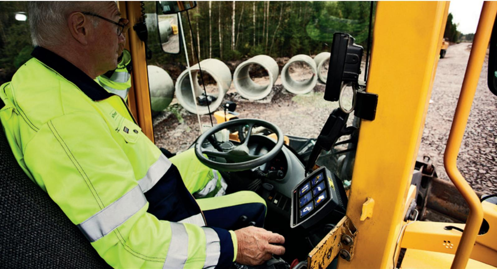
Découvrez les avantages uniques de Leica iCON iGW3 machine control – maintenant votre chargeuse peut elle aussi être guidée ! Rendez vos terrassements plus rapides et efficaces dès le départ. Economisez du temps et de l'argent en réduisant les reprises et en éliminant la surexcavation et le contrôle de niveau.
