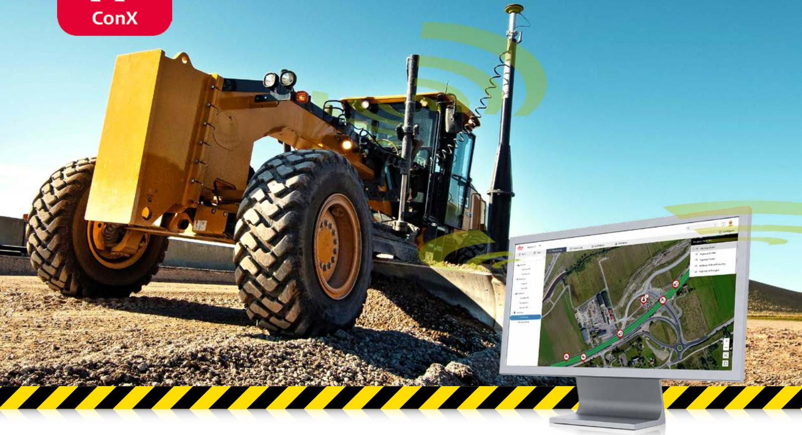
**Leica ConX ist eine cloudbasierende Lösung und ein Web Interface zur Verwaltung, Visualisierung, Aggregation und Weitergabe von 3D-Konstruktions- und Vermessungsdaten bei Hoch- und Tiefbauprojekten in Echtzeit.**
