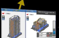
Die "Zlider Bar" ermöglicht Ihnen das vertikale Abschneiden von Gebäudemodellelementen für die bestmögliche Kartendarstellung
