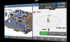
Objektorientierter Absteckungsprozess mit automatisch generierten Objektecken und -kanten
