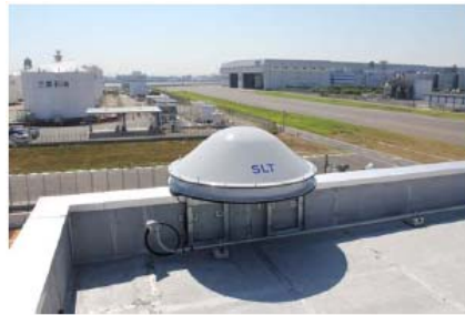
図 4 免振装置を施した基準局アンテナ
