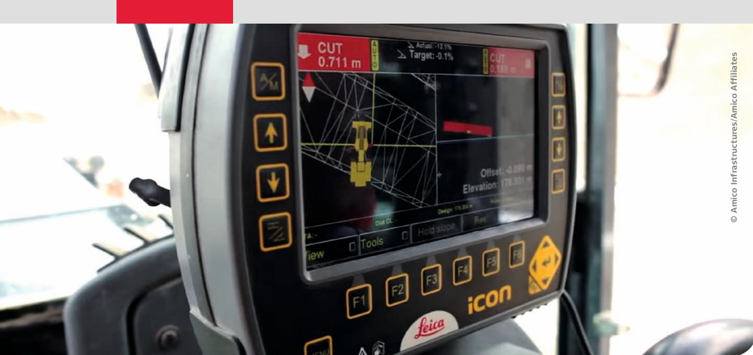
■ Les données de correction GNSS fournies par SmartNet ont aidé Amico à effectuer des travaux de nivellement précis.
