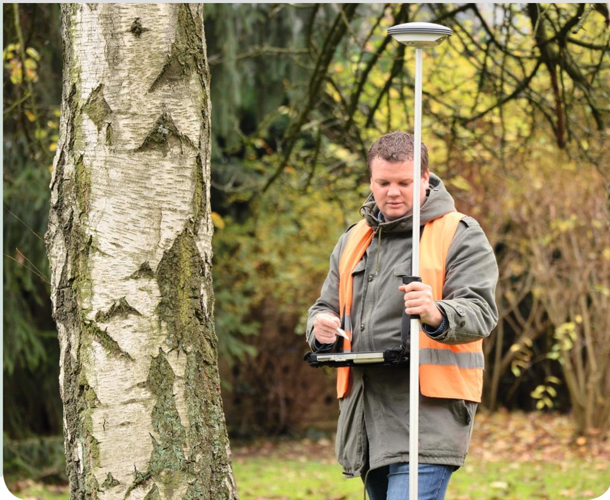
warebasis bildeten das Panasonic Toughpad FZ-G1 mit der Zeno GG03 GNSS SmartAntenne sowie der CS25 GNSS plus mit Helix-Antenne von Leica Geosystems.
