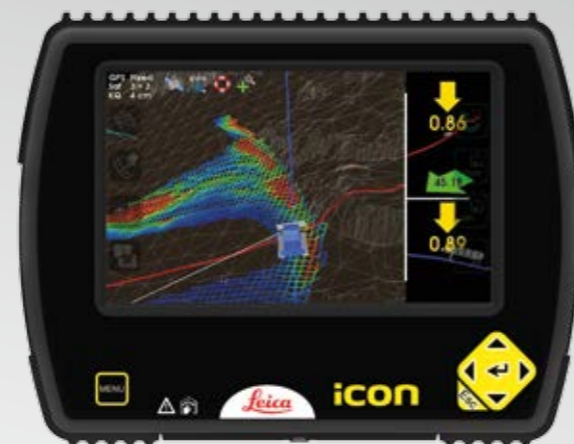
Anzeige der aktuellen Schneehöhe auf dem Maschinendisplay erlaubt autonomes Arbeiten
