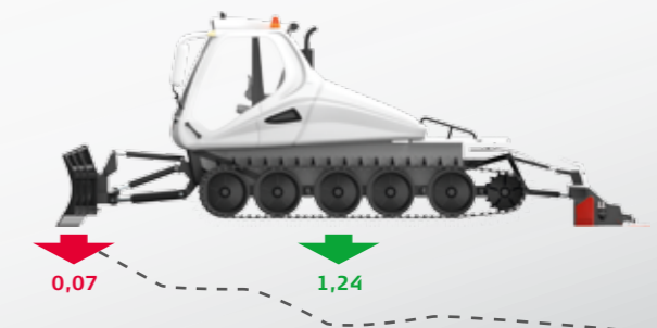
Anzeige der Räumschild-Position erlaubt präzises Freilegen von Zapfstellen
