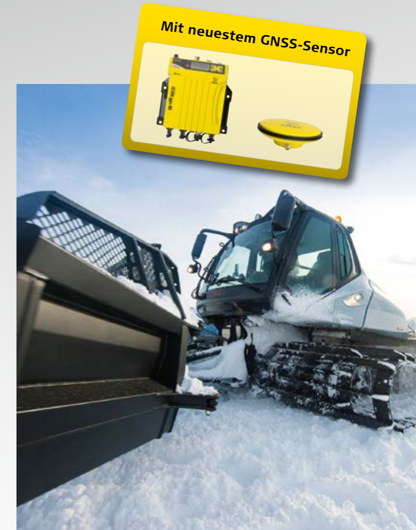
Anzeige der Räumschild-Position erlaubt präzises Freilegen von Zapfstellen
