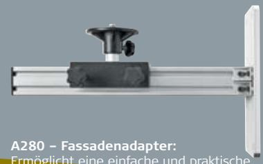
**A280 - Fassadenadapter:** Ermöglicht eine einfache und praktische Einrichtung des Lasers bei Anwendungen bei Fassaden. Der Zubehörsatz besteht aus zwei Adapterhalterungen und einer Schnurgerüstklammer mit 90°-Adapter für den Laserempfänger.
