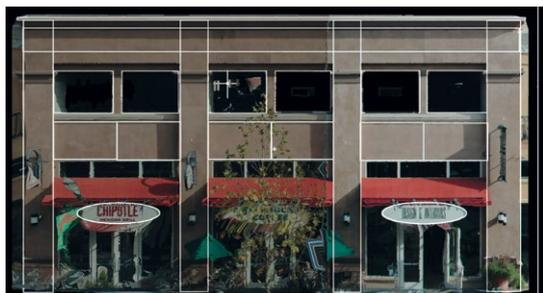
Les données des nuages de points sont utilisées dans CloudWorx pour faire des tracés sur les nuages et créer des plans filaires 2D ou 3D pour l'élévation des immeubles, les coupes, les plans de façades, l'extrusion de modèles, etc. Plusieurs commandes de CloudWorx facilitent ces tâches.
