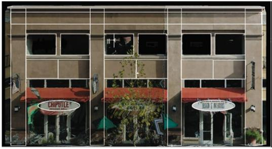
Les données des nuages de points sont utilisées dans CloudWorx pour faire des tracés sur les nuages de points et créer des plans filaires 2D ou 3D pour l'élévation des immeubles, les coupes, les plans de façades, l'extrusion de modèles, etc. Plusieurs commandes de CloudWorx facilitent ces tâches.
