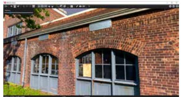
JetStream Viewer, de fácil uso, permite la navegación en 3D (compatible con uso de ratón 3D), visualización de imágenes HDR, medición, captura de pantalla de imágenes y vídeos, Quick Limit Box y, si está conectado al servidor JetStream Enterprise, acceso a los UCS guardados y limit boxes/slices.
