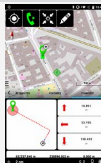
杭打ちツール
