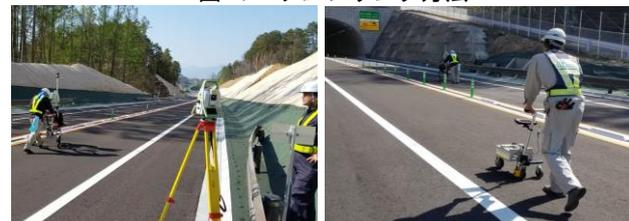
写真-2 Leica ProScan 及び MRP 測定状況
