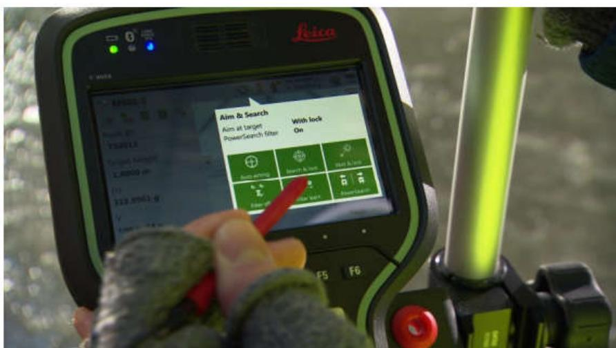
器械の周囲をスキャンすることで除外すべき対象を上記の内容で記憶しますが、既に設置している器械点も後で除外対象に含みたい場合は器械点設定実行中に設定することができます。
