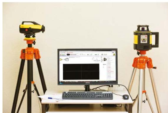
**Fig. 1.** Leica CalMaster – système de contrôle, de calibration et de certification pour les lasers rotatifs.
