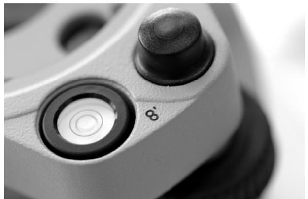
Figure 4 - vue détaillée de la nivelle sphérique GDF121
