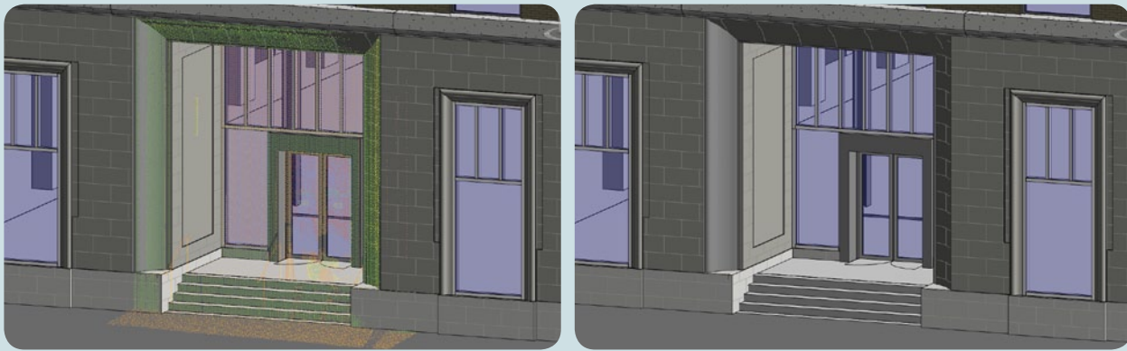
■ Mit Leica CloudWorx für Revit können aus Punktwolkendaten direkt Gebäude in 3D modelliert werden.
