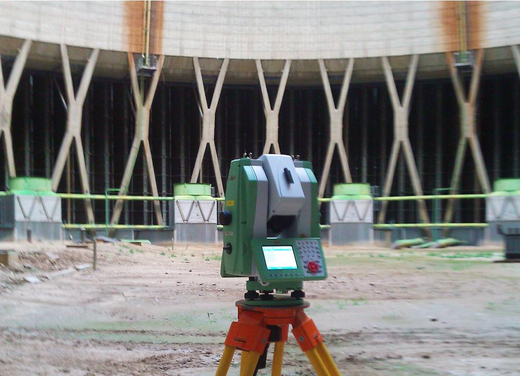
Die Leica Nova MS50 scannt die Innenschale eines Kühlturms.
