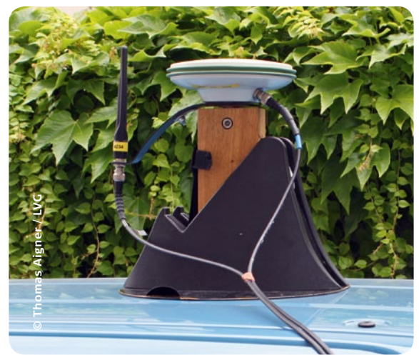
■ GSM- und GNSS-Antennenaufbau
