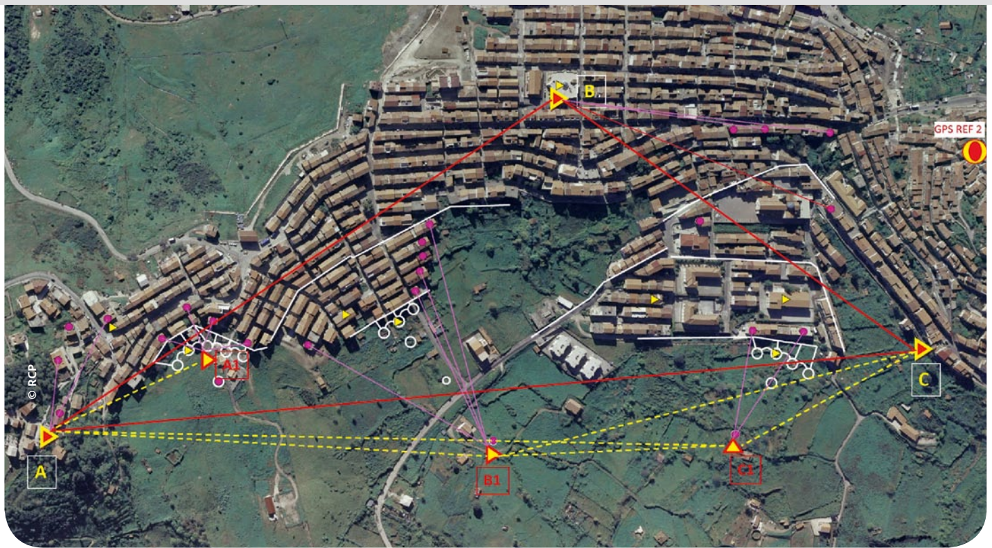
■ Monitoring-Netzwerk mit GPS-Basislinien (rote und gelbe Linien) und Beobachtungen mit der Totalstation (violett).
