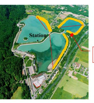
Auf Grund des speziellen geologischen Aufbaus (Illschotter über wasserlöslicher Schicht) besteht im Bereich der Speicherseen beim Kraftwerk RODUND Gefahr des plötzlichen Einbruchs der Erdoberfläche.
