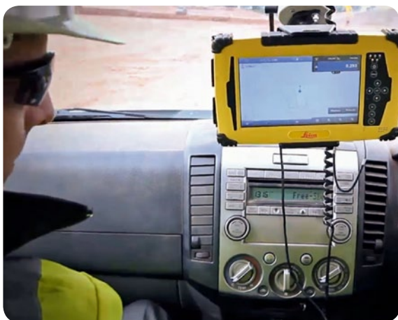
■ Höhenkontrolle: Leica iCON CC60 im Pickup.
