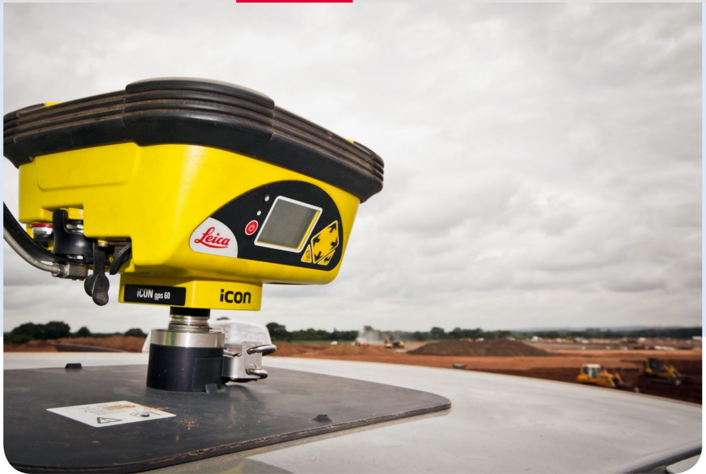
■ Leica iCON gps 60 auf dem Pickup-Dach: Der Projektleiter befährt das Gelände, um die Höhen zu prüfen.
