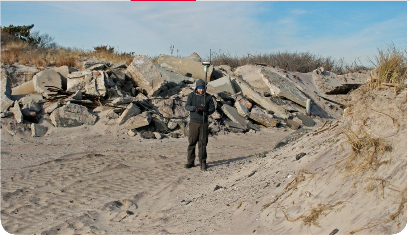
■ Ein Mitarbeiter von GdB erfasst mit einem Leica Viva GS15 die Sandabtragungen nach Sturm Sandy.
