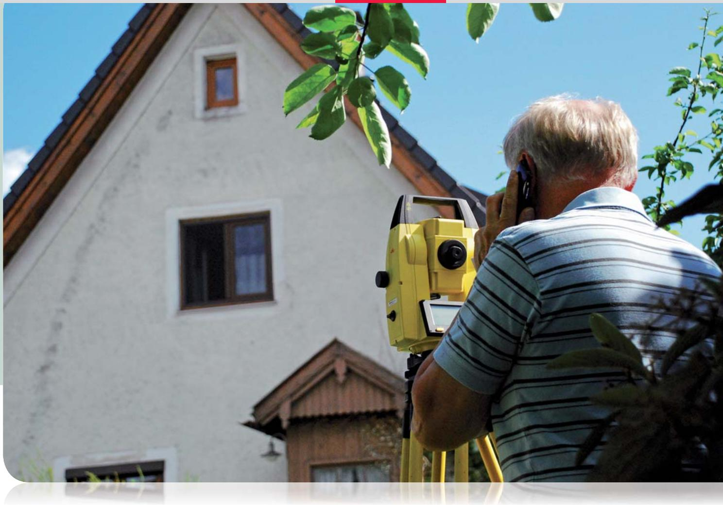
Nach einer Vorführung vor Ort bei einem seiner Kunden war Staudt beeindruckt von den Möglichkeiten, die der Leica Builder bot. Bereits auf der Baustelle machte er sich mit der einfachen und logischen Bedienung des Instrumentes vertraut. Ausgestattet mit berührungsloser Distanzmessung und benutzerfreundlichen Programmen, genügt es, die Eckpunkte des Daches von der Traufe bis zum First zu erfassen, um die Fläche und sogar die Dachneigung umgehend berechnet zu bekommen.
