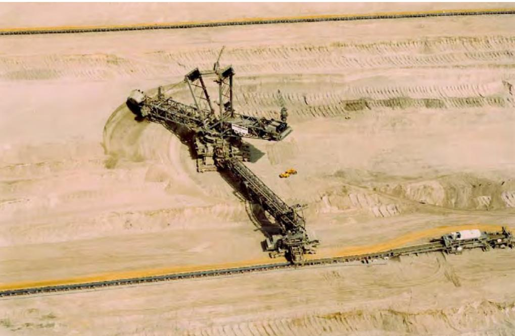
**In den drei großen Tagebaubetrieben Hambach, Garzweiler und Inden der RWE Power AG werden jährlich rd. 100 Mio t Braunkohle gefördert. Der Hauptanteil der Braunkohlenförderung wird zur Stromversorgung eingesetzt.**
