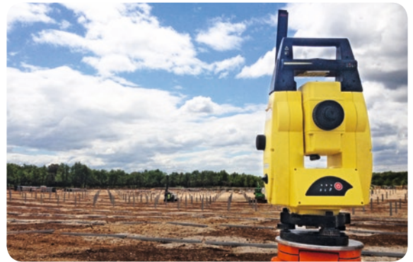
■ Präzise Absteckarbeiten mit dem iCON robot 50
