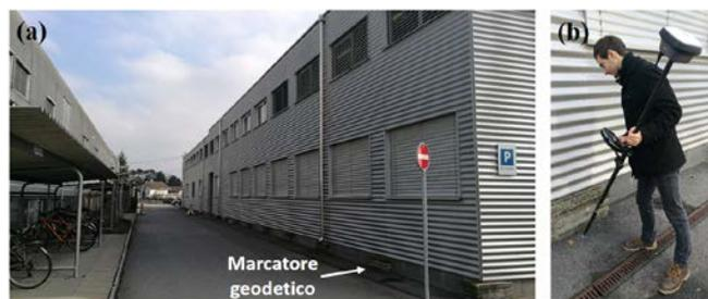
Figura 13: test di posizionamento RTK in un ambiente con multipath intenso (lunghezza della palina: 1,800 m) (a) Indicatore di rilievo vicino a un edificio con facciate metalliche, (b) Misura RTK di compensazione dell'inclinazione con Leica GS18 T.
