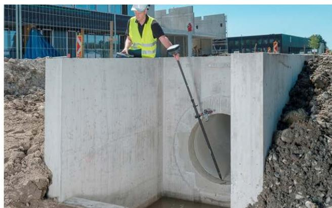
Figura 3: utilizzo di Leica GS18 T per misurare angoli di edifici e punti ostruiti che in precedenza non erano misurabili con palina verticale nel rilievo RTK convenzionale.
