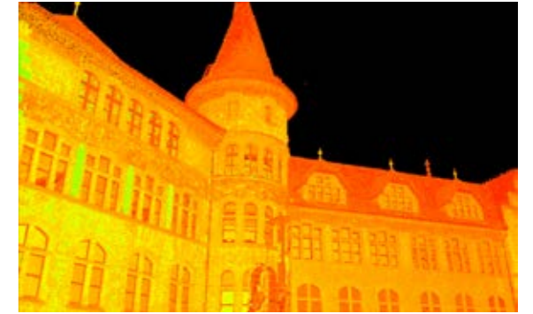
Figura 2: La scansione laser di un edificio fornisce molteplici dettagli. Questa vista mostra letteralmente in un unico contesto milioni di misurazioni; insieme, assomigliano ad una fotografia.
