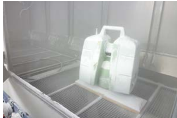
Figura 24: Particelle di talco sono molto piccole e sorprendentemente invasive, in particolare se hanno un giorno intero per farsi strada verso l'interno di uno scanner laser.
