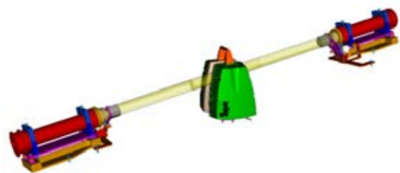
Figura 16: Il posizionamento agli antipodi dei telescopi AZTEC permette ai telescopi di osservare la loro posizione relativa, quando lo scanner viene rimosso. Questa è una torsione brevettata sull'idea di tecniche di auto-collimazione che permette criticamente per archi al secondo livello di osservazione e la calibrazione degli scanner laser.
