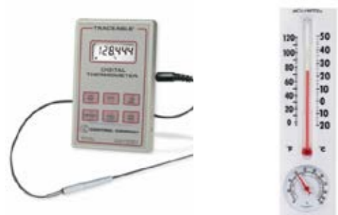
Figura 6: Il termometro tracciabile a sinistra è molto più costoso del termometro Acurite® a destra, di cui non è esplicitamente data l'incertezza. Il termometro tracciabile a sinistra è molto più costoso del termometro Acurite® a destra, di cui non è esplicitamente data l'incertezza.
