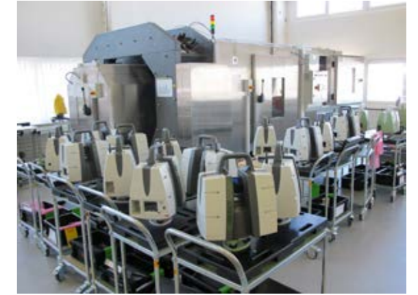
Figura 13: Una collezione di scanner P40 attesa del loro turno sul Rig ATEC calibrazione. Per l'occhio umano, sono perfettamente identici, ma l'occhio umano non è progettato per discernere micron. Ogni telescopio agli antipodi (ATEC) nella camera ambientale, è unico come uniche e distinte sono le impronte digitali umane.
