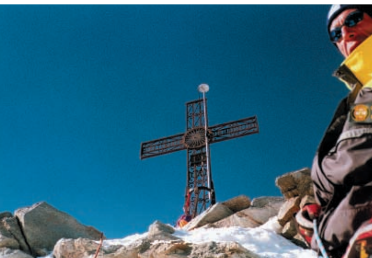
Einer der Punkte für die Gipfelvermessung war das Gipfelkreuz des Matterhorn, hier mit einer SR500-Ausrüstung.
