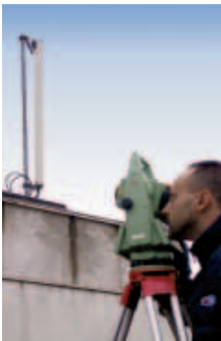
Messung von Antennen-Neigung und Höhe
